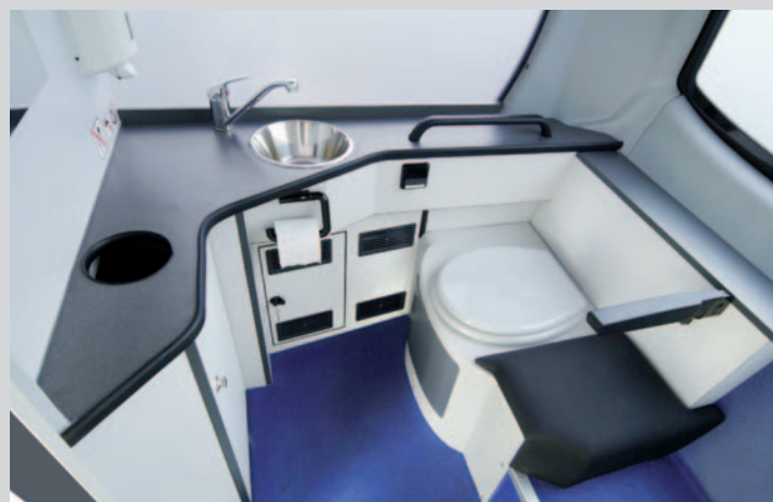
Индивидуальный подход – туалетная кабина для инвалидов Individually equipped – e.g. water closet for handicapped passengers
